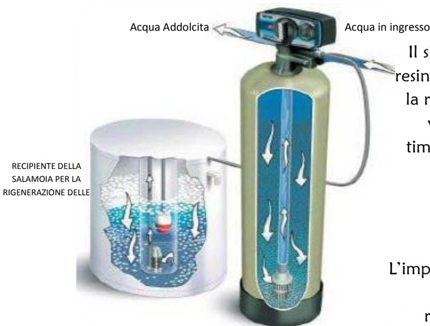
Il sistema è costituito da un contenitore per le resine, un contenitore per il sale (necessario per la rigenerazione periodica delle resine) ed una valvola idropneumatica che, pilotata da un timer programmato, effettua i cicli di lavaggio necessari a tenere in efficiente operatività l'apparecchio.
